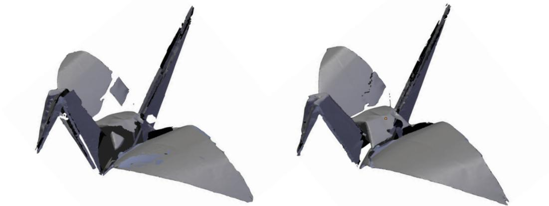
3D スキャンでは物体の表面が空間内でどのような位置にあるのかの情報をいくつかの点データとして取得します。そしてこの点データを仮想空間の中に配置し、点同士の隙間を線分や面で埋めることで、物体を多面体として表現しています。もちろん一周  $360^\circ$  の分割数（スキャンの角度）が多い方が、物体表面を表す点データをたくさんの方角から得ることができます。分割数が少なければその分隠れて見えない部分が多くなってしまい、その部分は物体表面の点データを取得することができません。この場合、どのように表面が繋がっているかが分からないので、取得した点データ同士を線分でつなげることができず、データに穴が空いてしまうのです。
