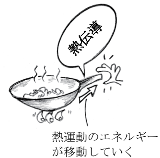
図3.1 熱伝導の例：原子間の相互作用で熱運動のエネルギーが移動していく。
