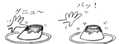
図4.3 ずれ弾性の例:グニュ〜と歪めても、パツともどに戻る。
