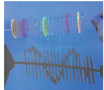
図2.1 “くしだんご”(上)とその影(下)。円板を棒に等間隔で差し, 球は 30^\circ 間隔で接着してある。
